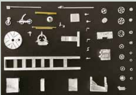
Auslegen und Entgraten der Gussteile.
