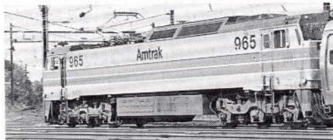
Heute verkehren 47 moderne, nach europäischem Vorbild gebaute E-Loks AEM7 mit 7000 PS (Lizenzbau von ASEA) mit einer Reisegeschwindigkeit von 125 mph (200 kmh). Daneben sehen wir noch oft die Metroliner-Triebzüge. Diese haben einen flugzeugähnlichen Querschnitt, einen Chromstahlkasten und einen einseitigen Führerstand.
