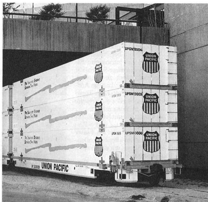
Werden in Zukunft Autos in solchen dreistöckigen Containerwagen über Eisenbahnschienen rollen? In Mai 1990 präsentierte Union Pacific an einer Messe in Atlanta diese Konstruktion (Foto: Scott Lindsey).
