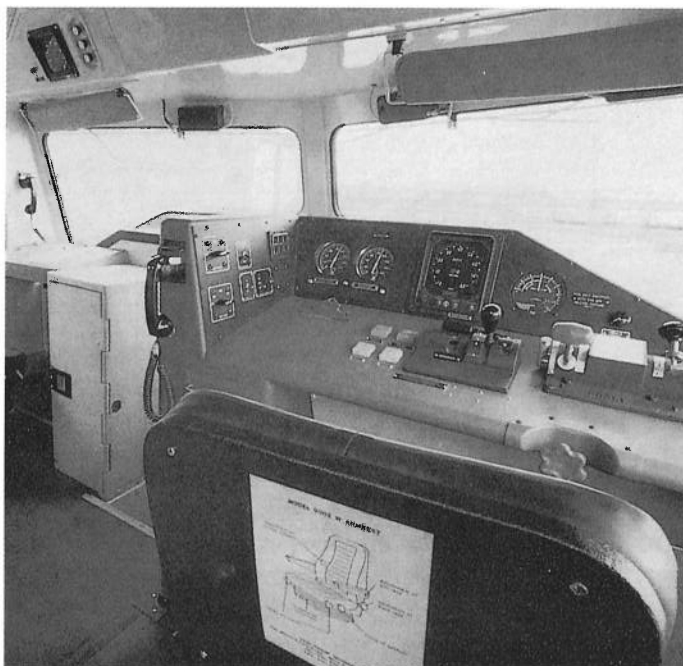
Das Innere amerikanischer Führerstände nimmt bei Loks neuer Baureihen immer mehr europäische Formen an: «cab interior» einer GP60M der Santa Fe (Foto: Santa Fe).
