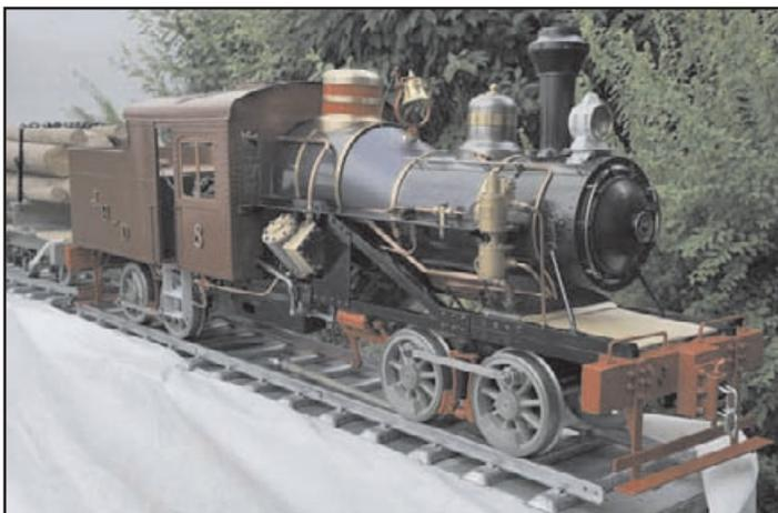
Dampfmaschinen haben mich schon immer fasziniert. So habe ich mich auch an den Bau dieser Lok gewagt. Es ist eine 2-Truck Heisler für 7 1/4 Zoll Spurweite. Dieses Modell ist im Eigenbau (Scratchbuilt) als voll funktionsfähige Live Steam Lok in unzähligen Stunden entstanden. Auch der dazugehörige Log Car habe ich selber gebaut.
